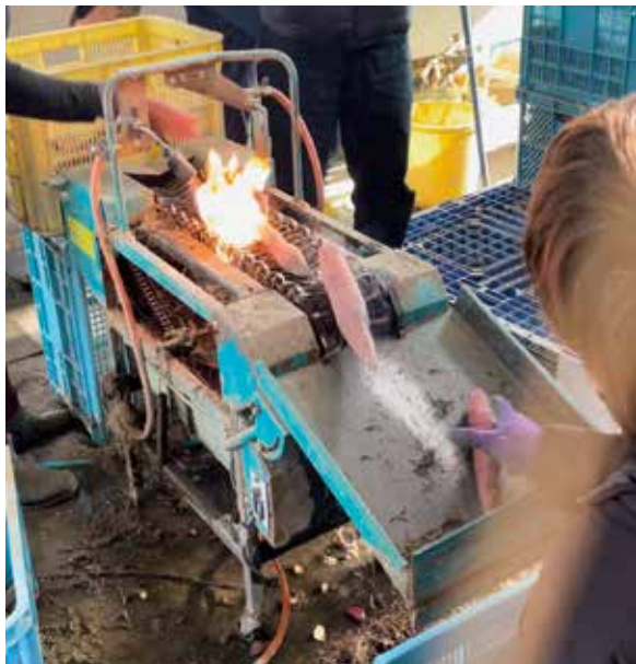
JA里浦で部会員らが見学したサツマイモのひげ根を焼く機械
